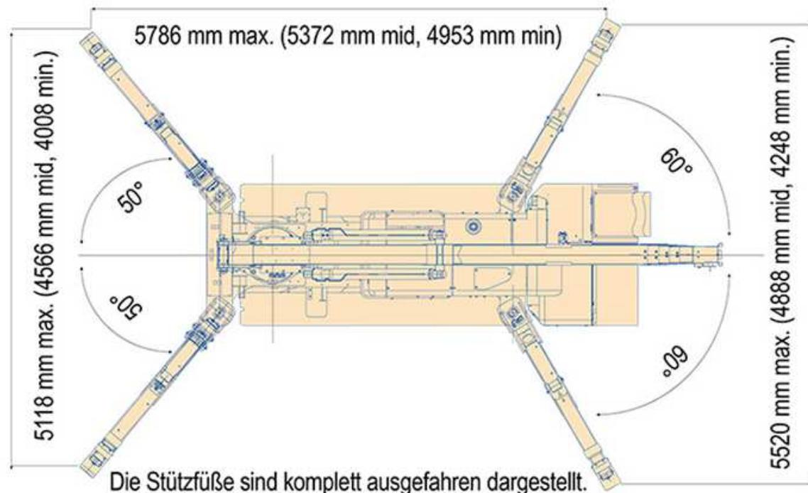
Highlight der Abstützung: Jede Stütze kann individuell ausgefahren und abgestützt werden.
