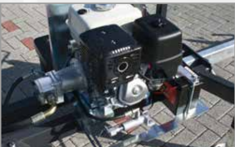
Benzinmotor mit E-Starter (optional)
